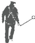
Caída FACTOR 1 punto de anclaje situado al mismo nivel del punto de anclaje dorsal del arnés
