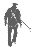
Caduta FATTORE 2 il punto di ancoraggio è situato sotto il punto di ancoraggio dorsale dell'imbracatura
