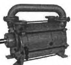
Вакуум помпи и компресори с воден пръстен, едноствъпални и двуствъпални с приложение в: централна вакуумна система, обезвъздушаване, импрегниране, процеси на кипене, вакуумно кондензиране, дистилиране, изсушаващи системи, стерилизация и филтрация
